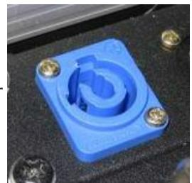
Il sistema Powercon (mostrato nella figura a destra) è invece utilizzato per alimentare con la corrente le casse in catena da una singola presa di corrente. Assicurarsi sempre di rispettare i limiti massimi di corrente di apparecchiature, cavi, etc. Poiché la presa di corrente fornita in dotazione alle OUTSIDER318 sopporta un massimo di 16A, è possibile collegare fino a un massimo di 3 casse in cascata (inclusa la prima collegata alla rete elettrica).
